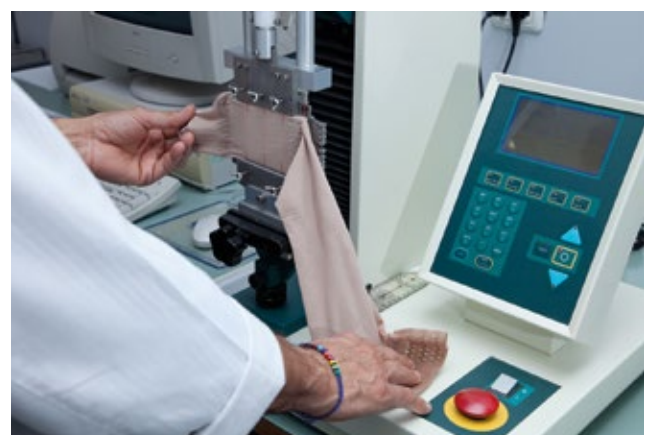
Misurazione della compressione con dinamometro
